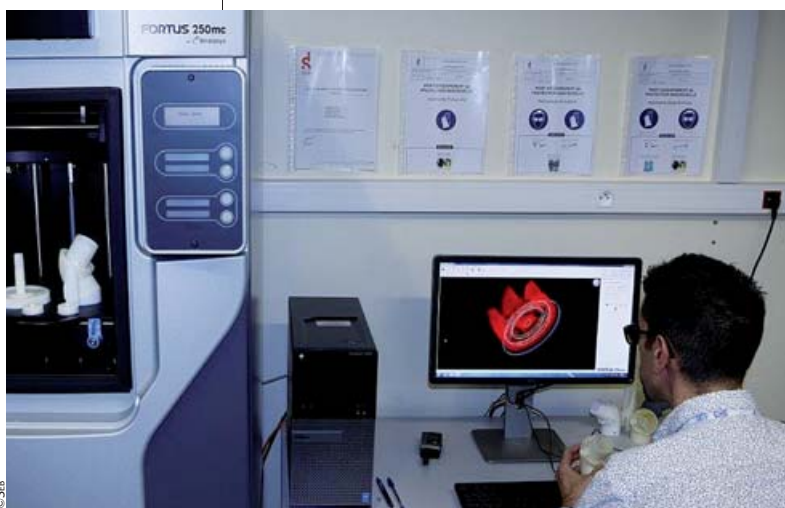
L'impression par dépôt de fil assure une fabrication abordable
