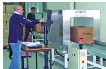
Lorsque les cartons arrivent sur le centre logistique, chaque article est détecté automatiquement, sans ouvrir le carton, via un « tunnel RFID » fourni par Tagsys.
