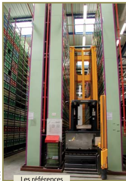
Les références qui ont une rotation plus faible sont stockées en grande hauteur.
