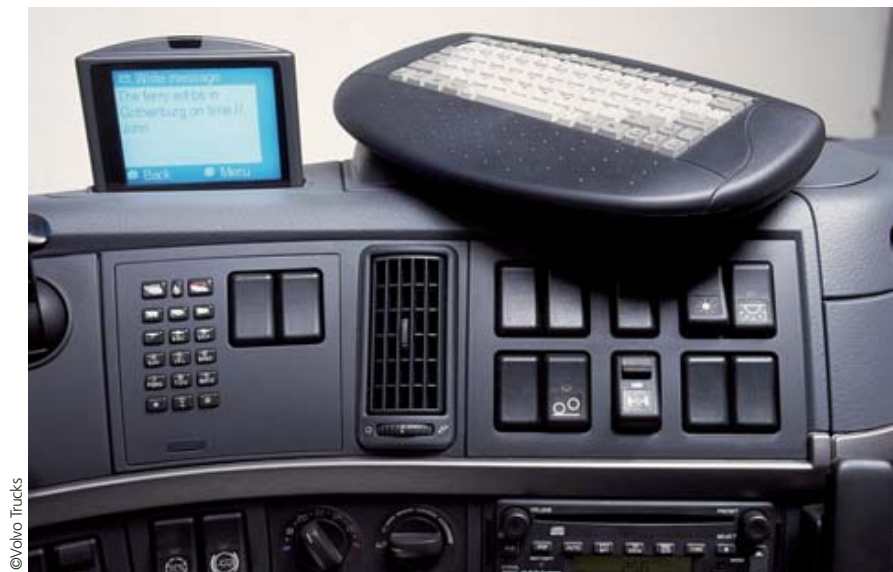
Dynafleet de Volvo associe un écran à un clavier complet pour la saisie des messages
