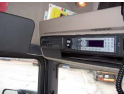
Le boîtier Elomobile assure l'échange de message entre le conducteur et l'entreprise.
