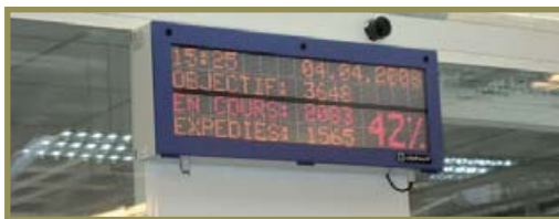
Un tableau affiche le nombre de commandes restant à préparer par rapport au total qui augmente jusqu'à 18 h 30. Si la cadence moyenne permet de finir avant 21 h, le chiffre est en vert, sinon, en rouge.
