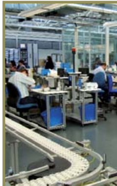
©DR La nouvelle organisation des lignes de montage a réduit la casse de 30 %.
