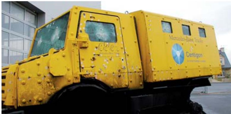
Ce véhicule sert aux tests balistiques de Centigon
