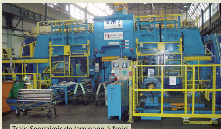
Train Sendzimir de laminage à froid.
