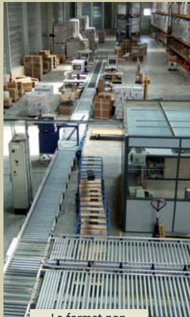
Le format non standard des produits impose des solutions spécifiques en termes de dimensionnement des rayonnages, d'outils de manutention, de manière de stocker.
