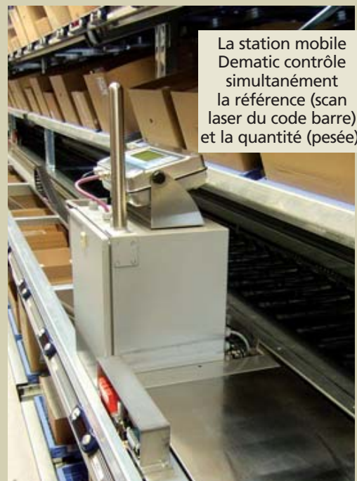
Le Pick-to-light indique le nombre de boîtes à prélever sur chaque emplacement concerné.
