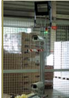
Chaque portique comporte un projecteur et deux caméras. Ils transmettent leurs images à un système central qui les decode et compare les données réelles aux données théoriques.
